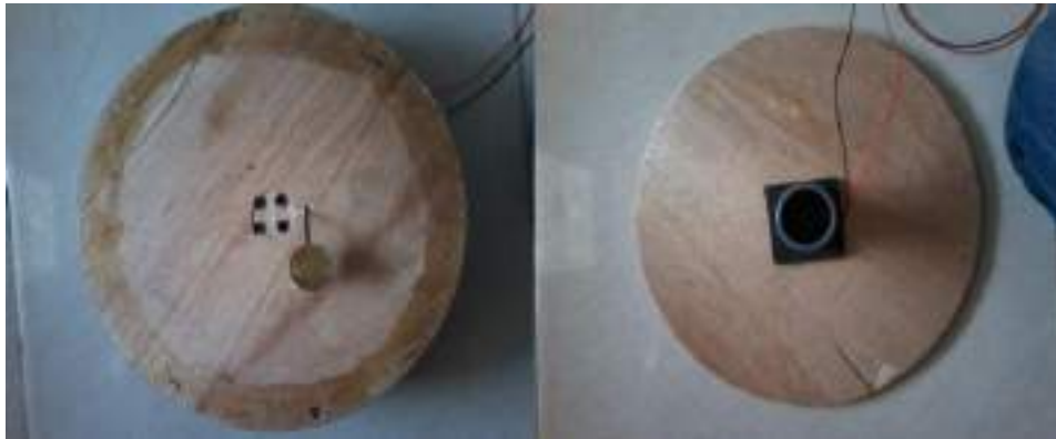
Gambar 6.7 Dasar Pad Drum Elektrik
