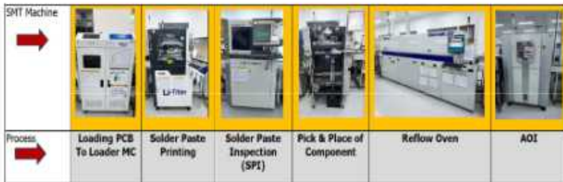
Gambar 2.4 Tahapan-tahapan proses di SMT Line
